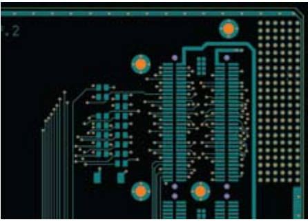
Рис. 6. Печатная плата без баланса меди
